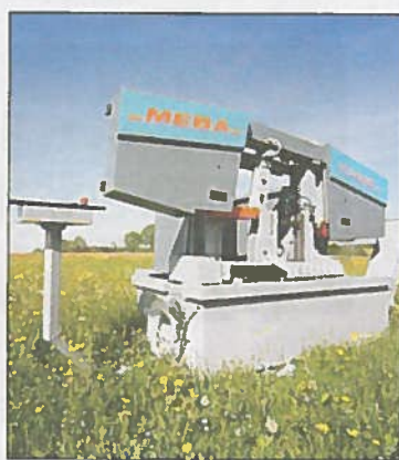
Den nye MEBAe-cut er den første serieresproduserte båndsagen uten hydraulisk motor, men kun med helelektrisk drift.
